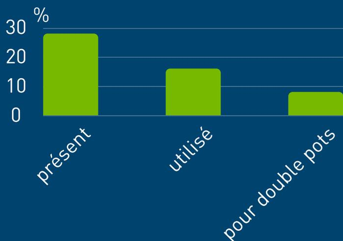
Les systèmes de captage des gaz d'échappement sont encore peu présents (1/4) et ne sont utilisés que dans 2/3 des cas où ils sont présents. Les dispositifs pour double pots sont encore trop rares.
